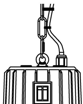
le câble est bien tiré le long de la chaîne et ne pas suspendre l'appareil au-dessus du câble !
