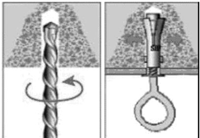
Aufhängeöse in das Loch. Sichern Sie ihn, indem Sie die Öse im Uhrzeigersinn drehen. Prüfen Sie, ob die Aufhängeöse in dem Keilbolzen ordentlich festgeschraubt ist, ob der Bolzen mit Öse starr festsitzt und ob das Ganze mindestens 10 kg zu tragen vermag.
