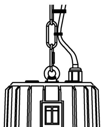
dass die Lampe am Stromkabel hängt! Leiten Sie das Stromkabel dann weg von der (heiß werdenden) Partytent-heater zu einer Steckdose.
