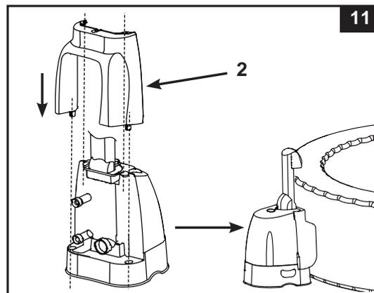
3. Insérez le boîtier de filtre dans la buse de refoulement de la cuve du spa (position inférieure, portant la marque « C ») (**voir dessin 12**). Gonflez le Spa avant d'installer les raccords de la filtration.
