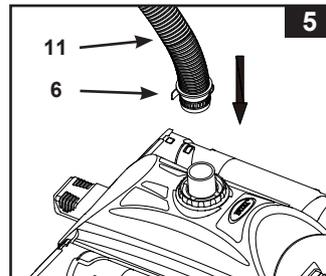
6. Placez le robot-aspirateur dans l'eau. Remplissez le tuyau d'eau en l'immergeant pour enlever complètement l'air restant dans le tuyau.
