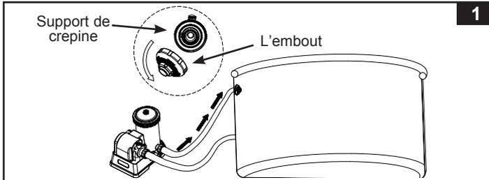
2. Vissez l'extrémité du tuyau A (8) avec adaptateur au support de crépine depuis l'intérieur de la piscine. Figure. 2.
