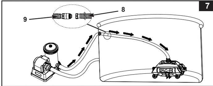
9. Allumez la pompe de filtration et assurez-vous que l'eau coule à travers le nettoyeur automatique. Le nettoyeur automatique est maintenant en mouvement et aspire le fond de la piscine. Figure. 8.
