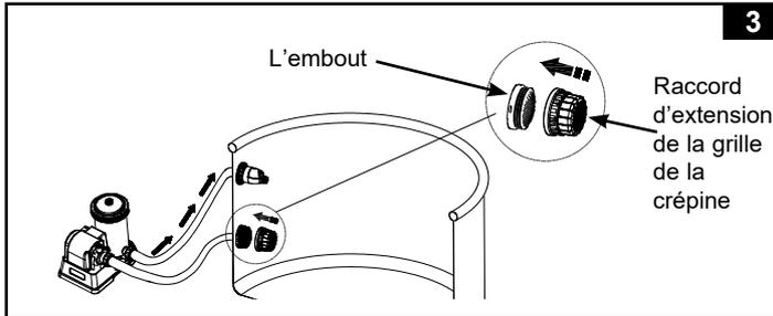
**NOTE :** Retirez les raccords d'extension des grilles des crépines (12) des grilles des sorties d'aspiration lorsque le dispositif de nettoyage automatique n'est pas utilisé ou débranché de la piscine.
