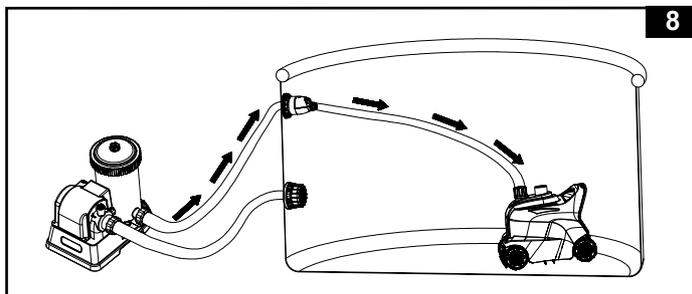
9. Allumez la filtration et assurez-vous que l'eau coule à travers le micro-filtre (5) et la valve de regulation de pression (6). Le robot se déplace et aspire le fond et les parois de la piscine. Figure. 9.
